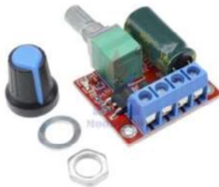
Рисунок 41 – ШИМ-регулятор скорости вращения источника возбуждения
