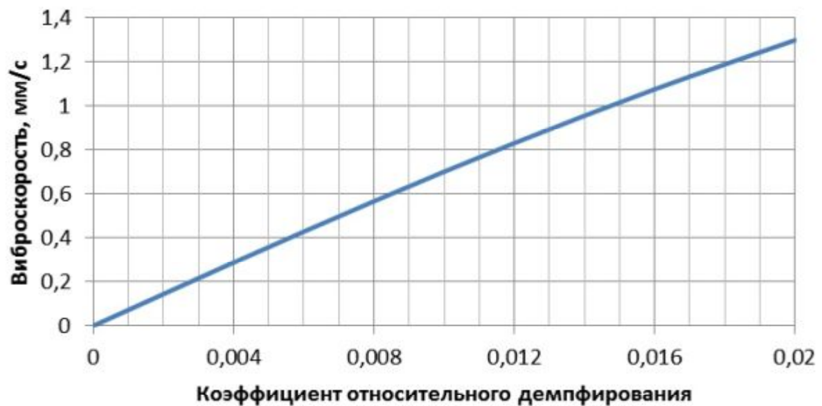
Рисунок 82 – Уровень виброскорости оборудования при применении системы виброизоляции с квазинулевой жесткостью, дополненной динамическим гасителем колебаний, при различных параметрах гасителя
