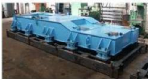
Рисунок 6 – Виброизоляционная рама ИПТЭР / ЗАО Ротор
