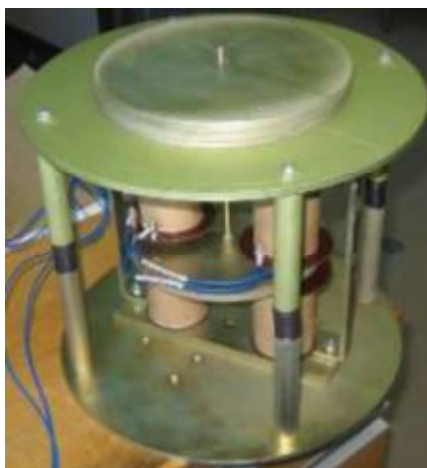
Рисунок 22 – Виброизолятор Гуровой и Зуева
