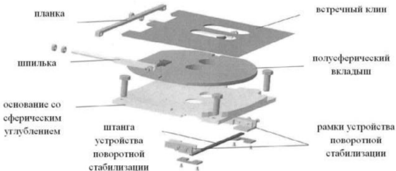
Рисунок 5 – Динамический гаситель вибрации для насосного агрегата
