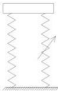
Рисунок 28 - Общий вид системы с квазинулевой жесткостью четверного типа, в которой содержатся активные элементы
