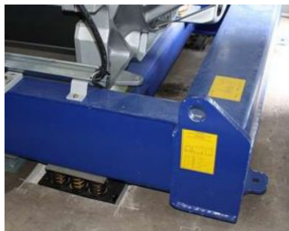
Рисунок 14 – Установка виброизолятора типа ДО на оборудовании
